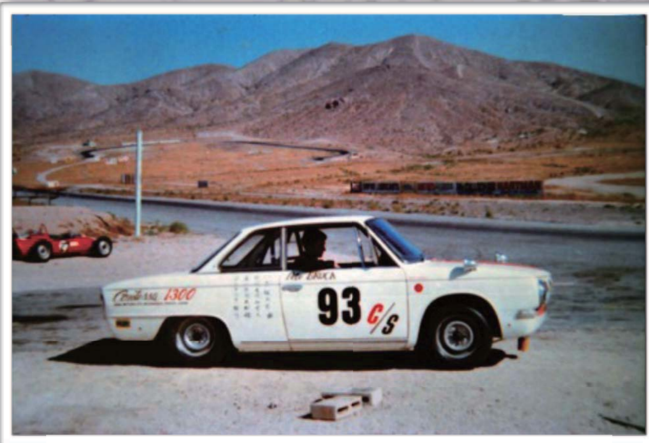
1966年5月、カリフォルニア州ロス郊外のウィロースプリングス・レースウェイにてテストを繰り返す。オイルクーラーをリヤからフロント下に。油温&油圧が大きな課題だった。
