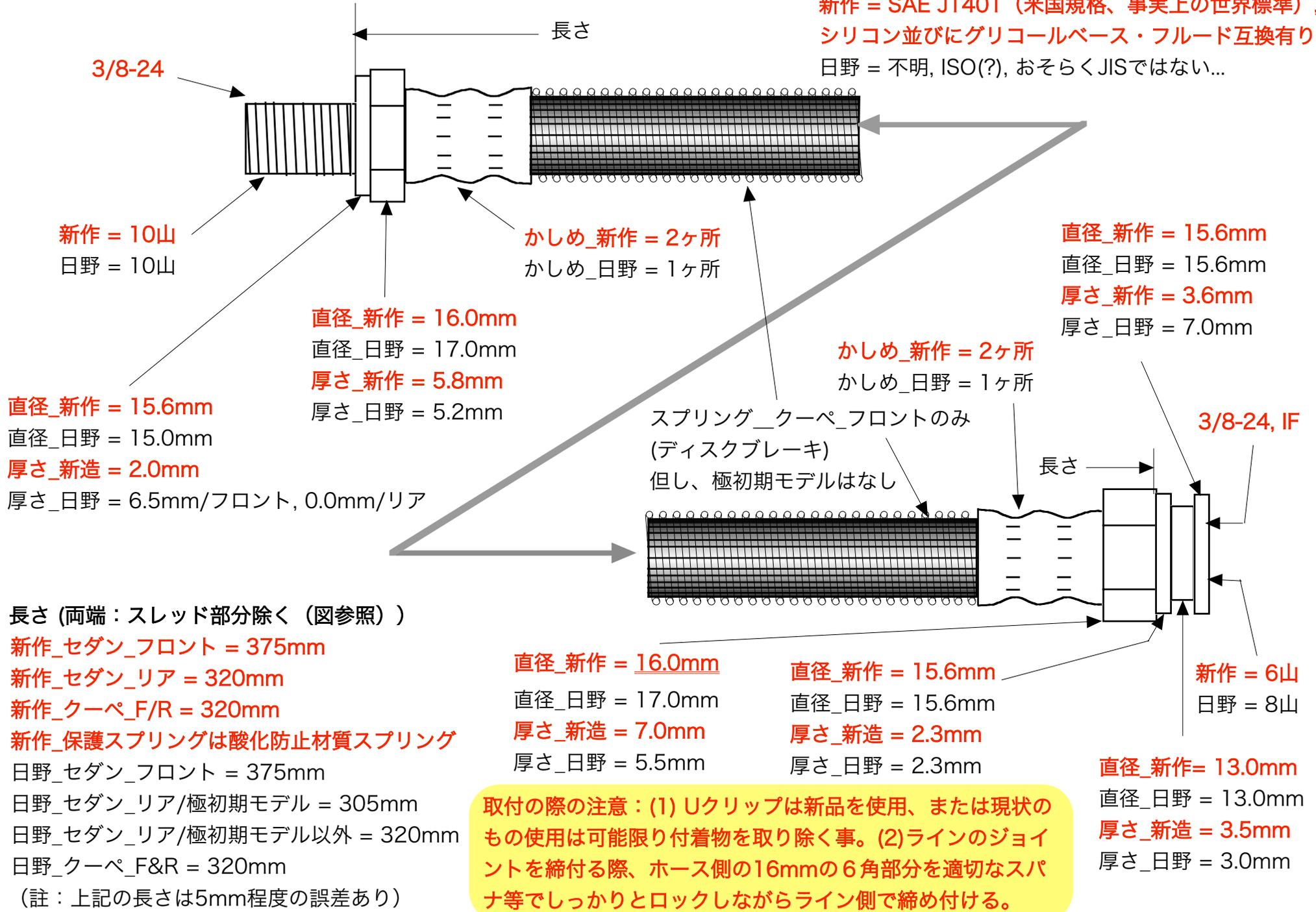
取付の際の注意: (1) Uクリップは新品を使用、または現状のもの使用は可能限り付着物を取り除く事。(2) ラインのジョイントを締付る際、ホース側の16mmの六角部分を適切なスパナ等でしっかりとロックしながらライン側で締め付ける。
