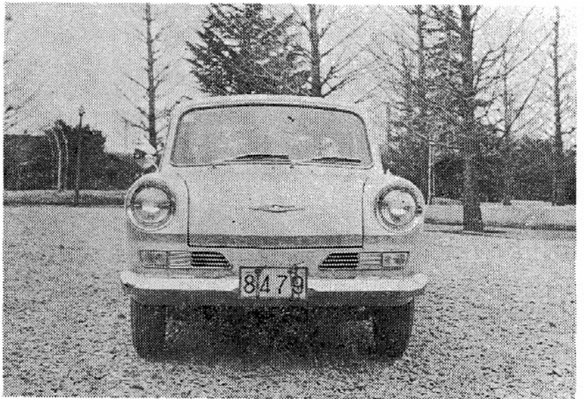
運動式ワイパーはセルフパーキング式。フェンダーミラーはデラックスモデルの標準品。左右の四角いランプはフラッシャー兼車幅灯で、その内側はヒーター用エア取入口である。
