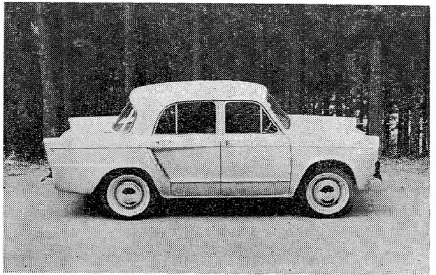
ルノーに比べ、全長で110mm長いだけだが、はるかに大きく見える。前後ドア共、前縁をヒンジとして広く開く。ルーフは後まで延びているので後席のヘッドルームは充分である。
