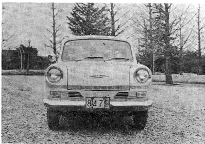
連動式ワイパーはセルフパーキング式。フンダーミラーはデラックスモデルの標準備品。左右の四角いランプはフラッシャー兼車幅灯で、その内側はヒーター用エア取入口である。
