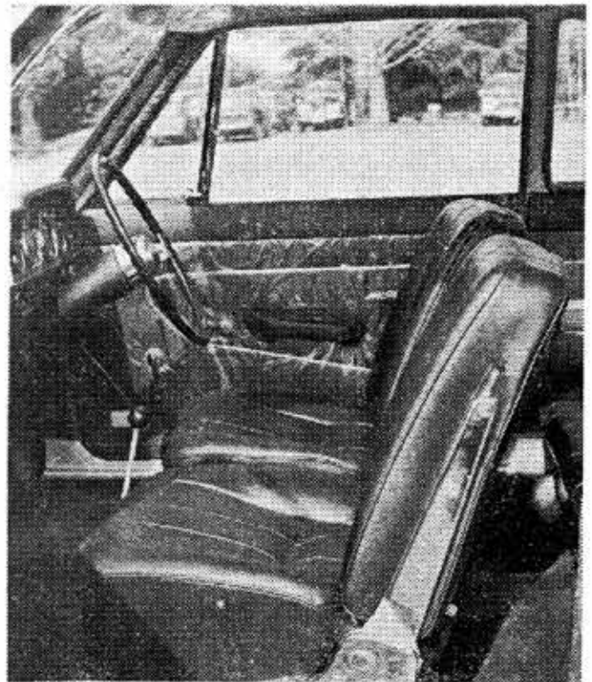
第7図 フロントはバケットで前後160mmのスライドができるリクライニングシートである。
