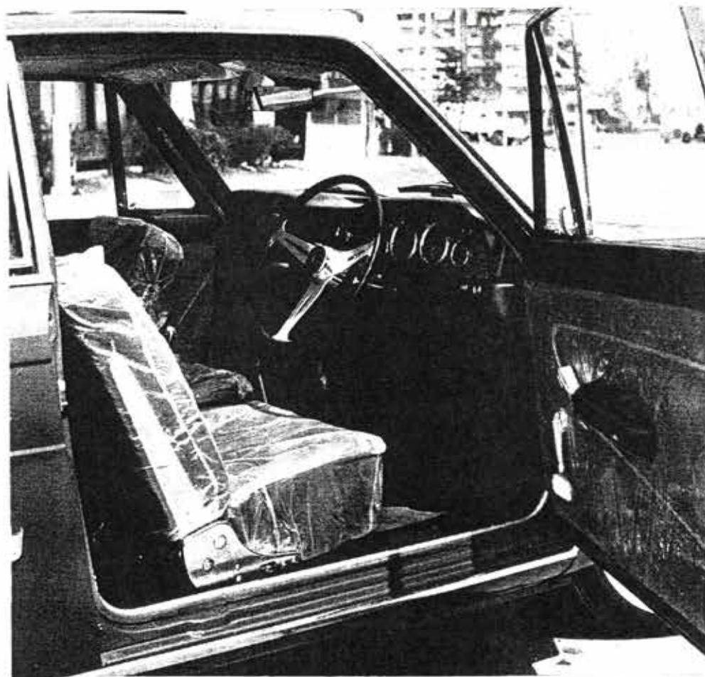
3本スポークのステアリング・ホイールの前方には、フードで覆われたパネルがあり、このパネル中央右に180km/hまで刻まれたスピード・メーター。左に7000rpmまでのタコ・メーター。レッド・ゾーンは6000rpmからである。シフト・レバーはセダンと異なり垂直である。
